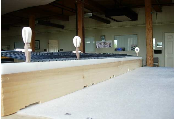
Fig. 22 Glue guide hammers
